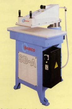
L'opérateur déplace le bras manuellement audessus de la lame de l'emporte-pièce et commande l'opération de découpe en pressant simultanément les deux boutons placés sur le haut des poignées. Une fois la course de découpe terminée, le bras remonte automatiquement. L'opérateur déplace le bras sur le côté, dégageant ainsi la table pour la collecte des pièces et le repositionnement de l'outil.
